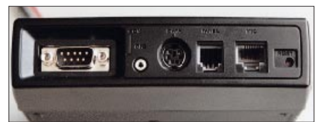
Bild 2: Gerätefront mit neunpoliger D-Sub-Verbindung, 2,5-mm-GPS-Klinke, Mini-DIN-TNC-Anschluß, Westernbuchsen für Mikrofon und Bedienteil sowie versenktem Reset-taster.
