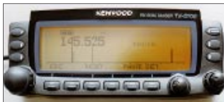
Bild 7: Das Spektrumdisplay umfaßt bei breiter Einstellung das gesamte 2-m-Band im 12,5-kHz-Raster. Ein Durchlauf nimmt nur 11 s in Anspruch – das ist Spitzenklasse!
